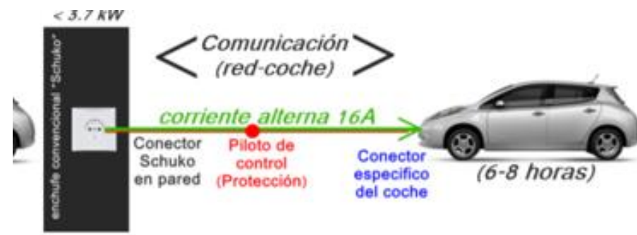
Il·lustració 1. Esquema Punt de Recàrrega Vehicular. Metodologia
