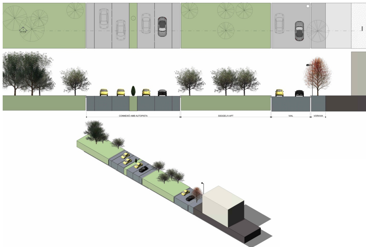
Imatge 31. Proposta de nova secció de la sortida nº25 de la Ma-13
