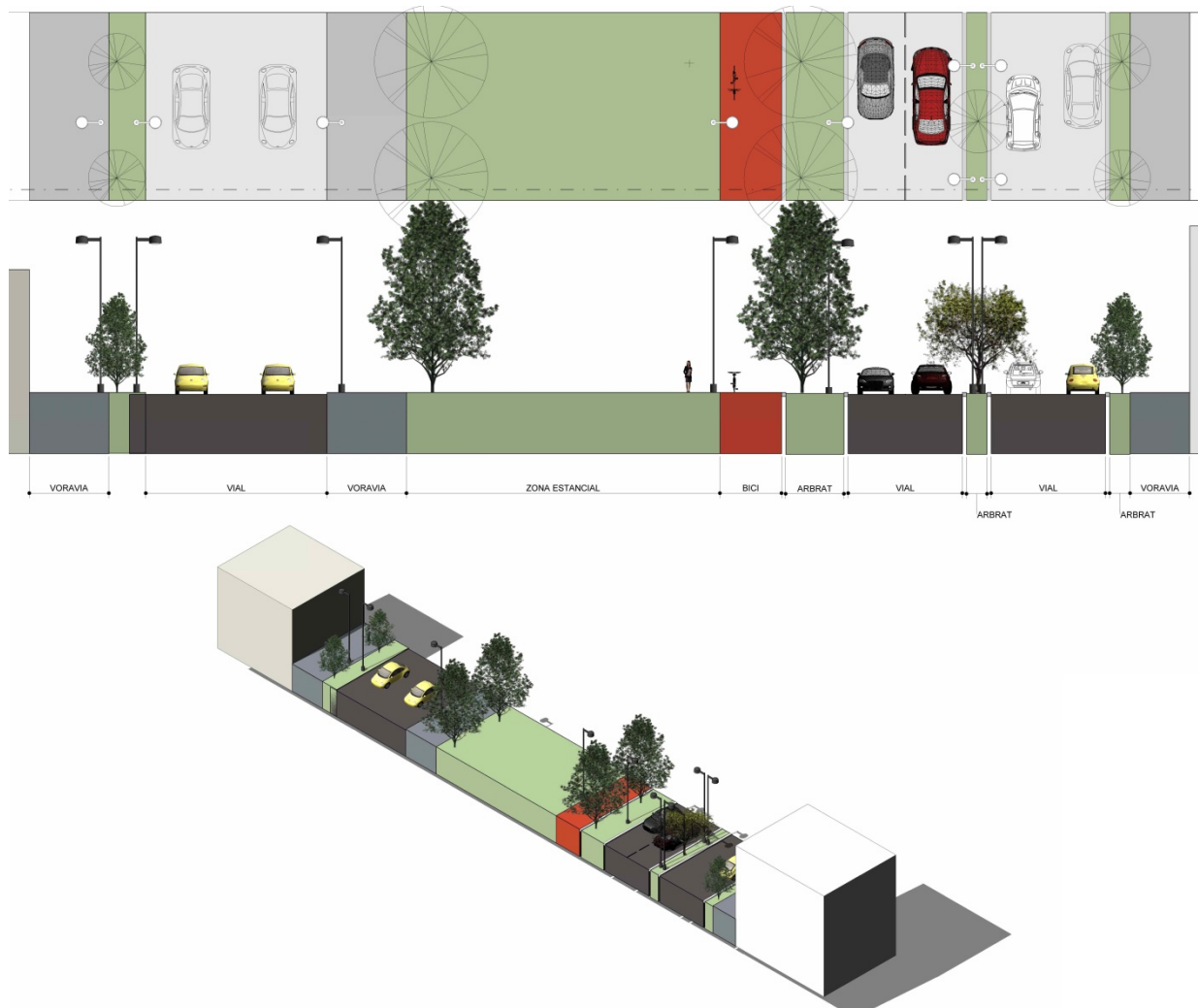
Imatge 41. Proposta de nova secció de la Ronda Migjorn
